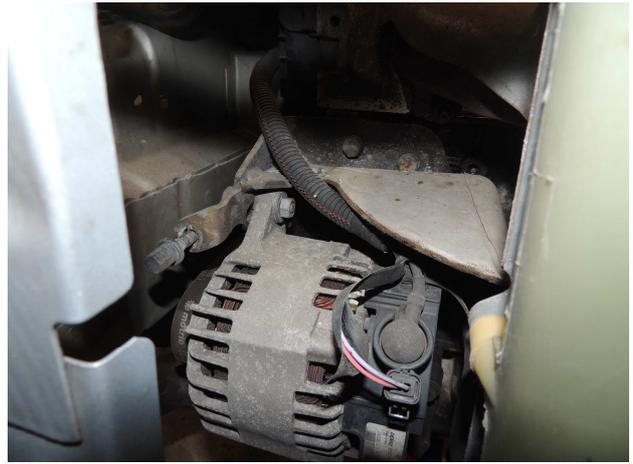
Repérez la position du tendeur ( 45 mm ) et détendre ( clé de 10 ) et enlever la courroie d'accessoire
