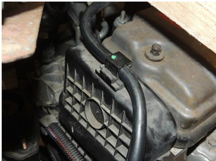
Remontez le support moteur ( 2 écrous clé de 13, 3 écrous clé de 16 )
