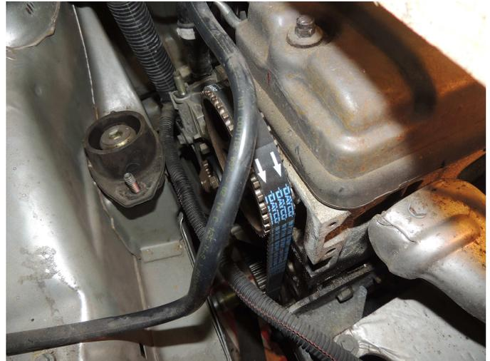
Mettre en place la courroie de distribution, brin "b" bien tendu, dans l'ordre suivant :
