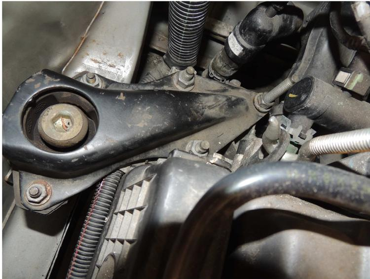
Déclipsez le tuyau de prise d'air
