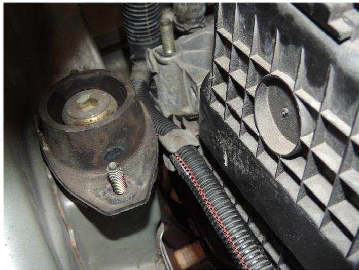
Démontez le cache de distribution inférieur ( 4 vis, clé de 10 )
